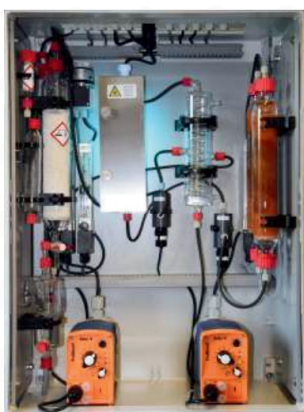
化工廠監測冷卻水內 是否有含氯有機物洩漏
